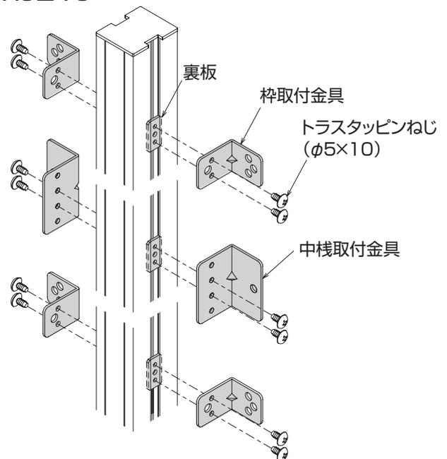
**4** 間柱取り付け位置に下穴（φ6）をあけ、間柱ブラケットを取り付けてください。
